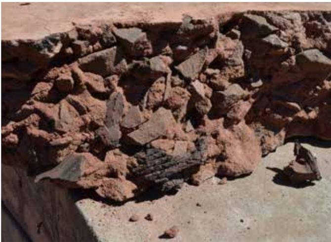
Detalhe do bloco de concreto com pneus na sua composição
